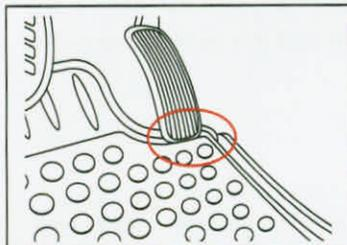
2. Verifique la siguiente operación del pedal (deprima totalmente el pedal), para asegurarse de que la alfombra de piso no interfiera con él. Compruebe que el motor esté apagado y que la palanca esté en la posición "Park" [estacionar] cuando haga la prueba:
