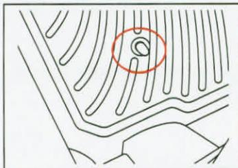
1. Asegúrese de que la alfombra de piso para el conductor esté apropiadamente asegurada con los ganchos de retención (clips). Confirme que dichos ganchos de retención (clips) esté fijos en los ojales con arandelas que están en el piso del vehículo (moqueta).
